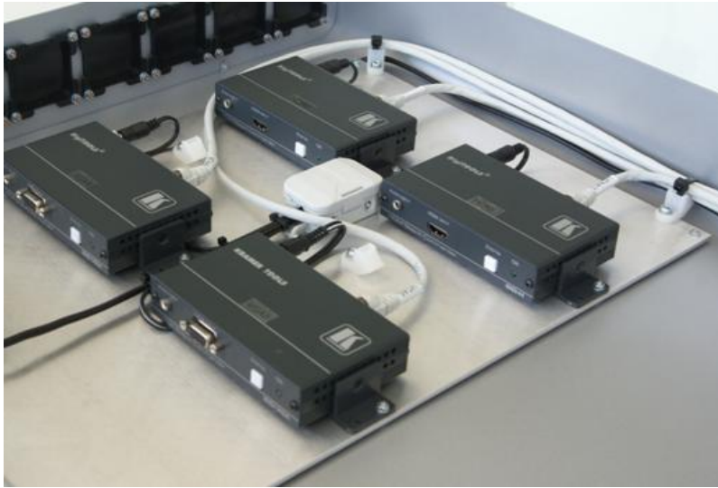
Abb. 17 Ausführungsbeispiel Trägerplatte mit aktiven Signalumschaltern und Zugenlastung
