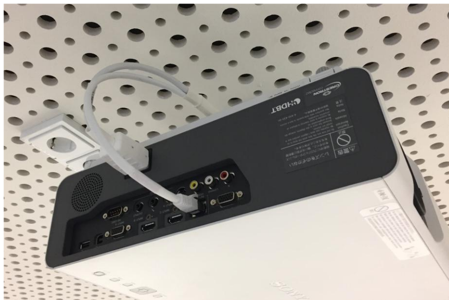
Abb. 21 Beispiel Anschlusskabelbaum Projektor
